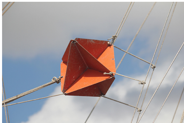
Rysunek 1.11 Reflektor radarowy podwieszony na olinowaniu jachtu jest rodzajem zwierciadła narożnego. Źródło: Tim Sheerman-Chase
