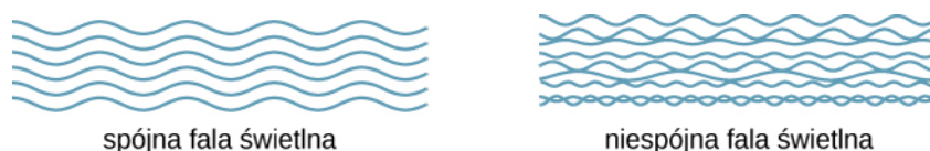
Rysunek 8.29 Spójna fala świetlna zawiera fale o tej samej częstotliwości i tej samej fazie. Fala niespójna składa się z fal o różnych częstotliwościach i różnych fazach.
