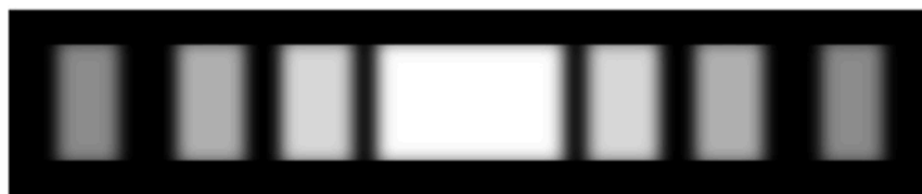
Rysunek 4.9 (a) Obliczony rozkład natężenia światła w dyfrakcji na pojedynczej szczelinie. (b) Rzeczywisty obraz dyfrakcyjny.
