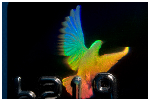
Rysunek 4.27 Karty kredytowe powszechnie mają logo na hologramie, dzięki czemu są trudne do podrobienia. Źródło: Dominic Alves
